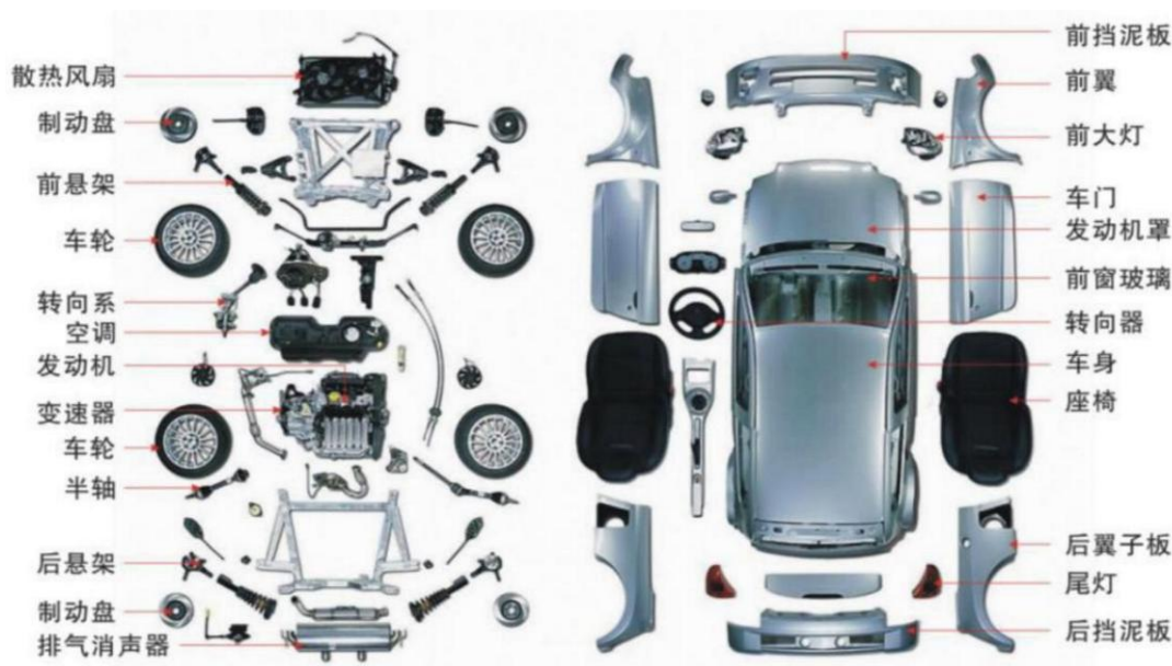
图 2-4 小汽车总成拆分平面图
